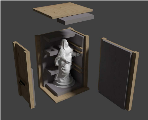
Figura 9. Infografía de embalaje por plantillas. Desarrollo de la mitad de las distintas partes que comprenderían el embalaje interno.
